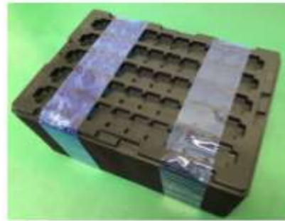
トレー 20 段 + 蓋 1 枚 → 低粘着テープ止め 1000 pcs = 1 梱包 ※MAX重ねた高さ130mm
