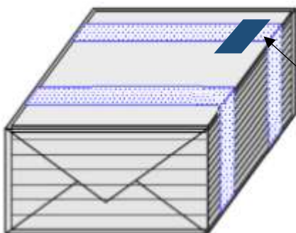
静電袋に入れテープ止め 450 × 350 × 0.05t (mm) ※トレー異物付着対策
